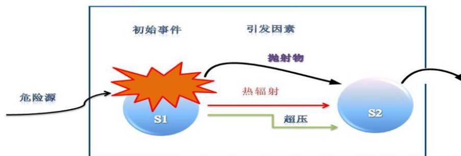
图 6.4-1 多米诺效应系统图
