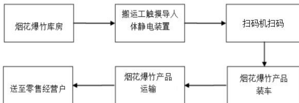
图 2.5-2 烟花爆竹出库工艺流程示意图
