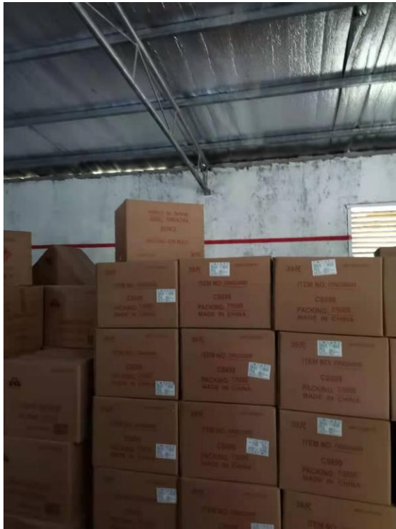
整改前：产品堆垛高度超过 2.5
