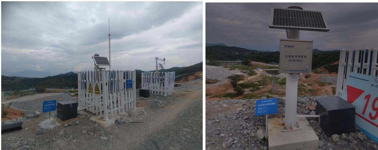
自左而右依次为在线浸润线、表面位移、内部位移监测仪
