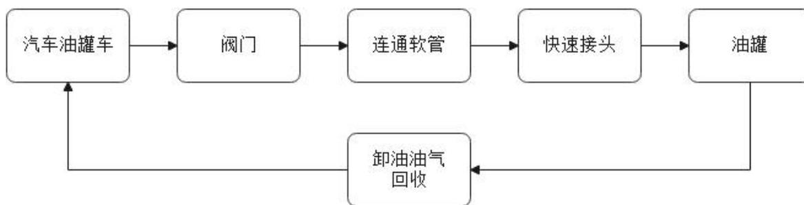
图 2.2.5-1 汽油卸油工艺流程示意图
