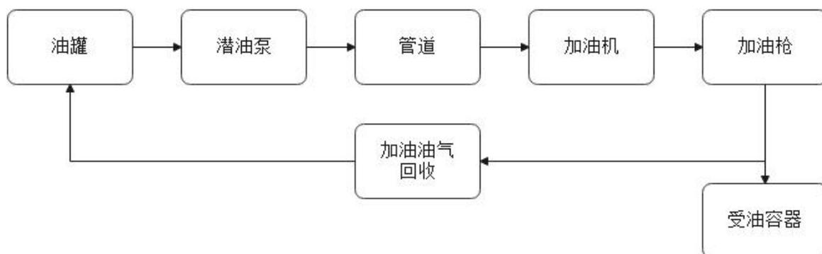
图 2.2.5-2 汽油加油工艺流程示意图
