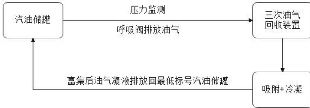
图 2.2.5-3 三次油气回收工艺流程示意图
