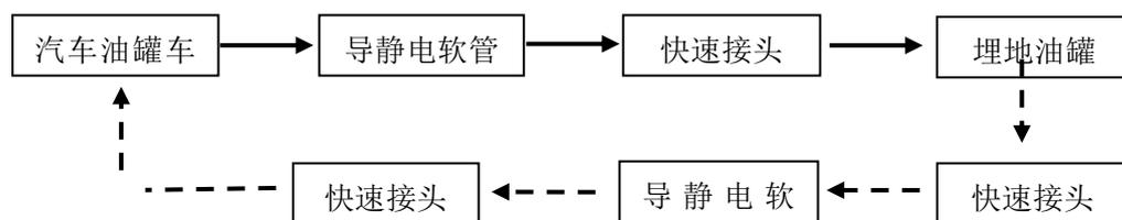
注：虚线箭头表示油气回收工艺路线。
