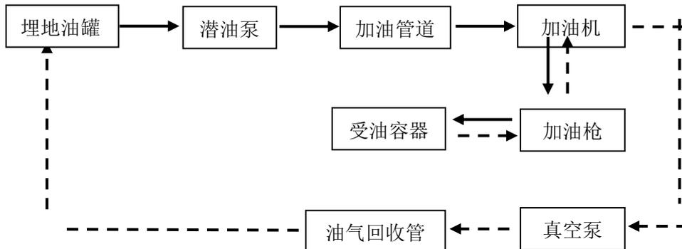
注：虚线箭头表示油气回收工艺路线。
