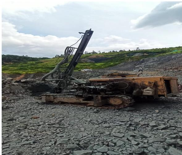
图 2-5 开山牌 KT5C 型一体式潜孔钻车
