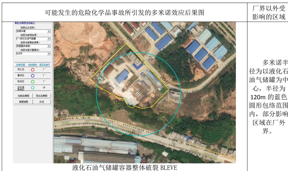
液化石油气储罐容器整体破裂 BLEVE
